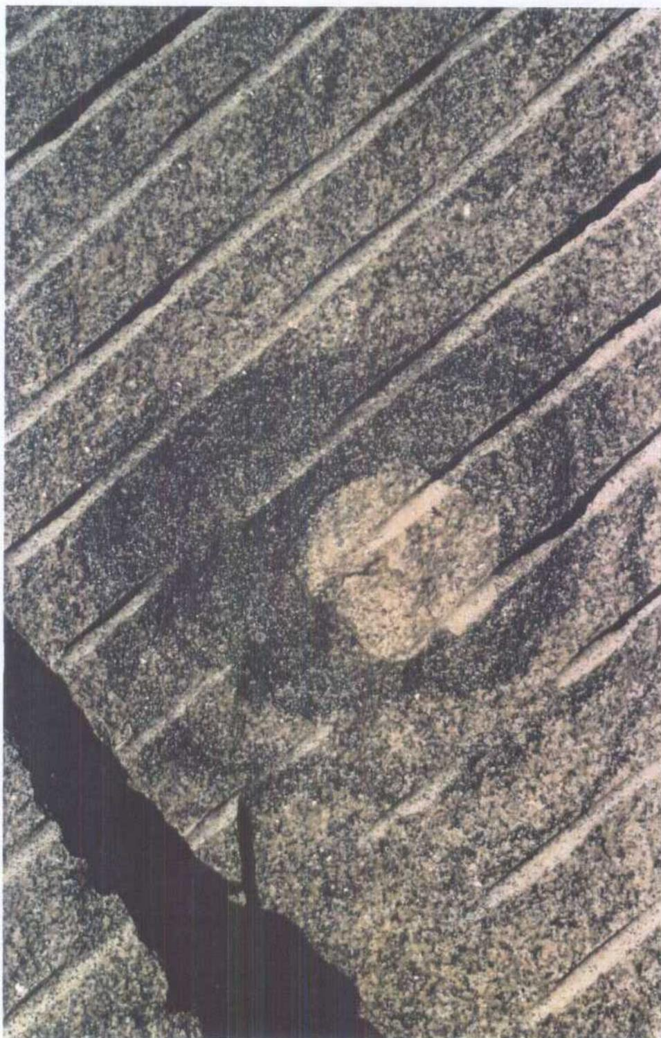
Figura 43 : Tubo o chimenea de flujo sobre la cara de un bloque.
